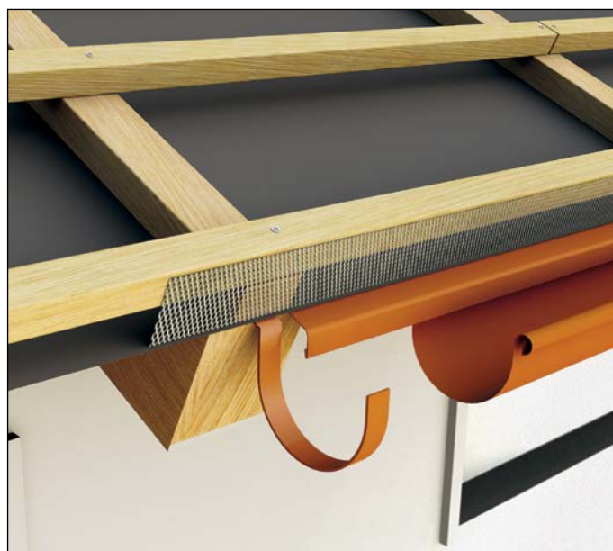
2. változat – Cseppentő lemez (fólialemez) az ereszcsonalába lógatva
