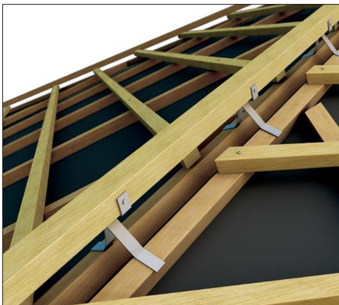
1. változat – Élgerincléc felrakása kengyel segítségével
