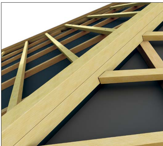
2. változat – Élgerincléc felrakása lécszerkezet segítségével
